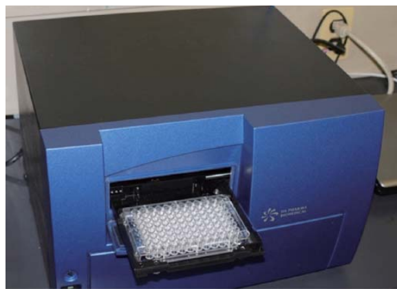
▲マイクロプレートリーダーを用いて 蛍光強度を測定
