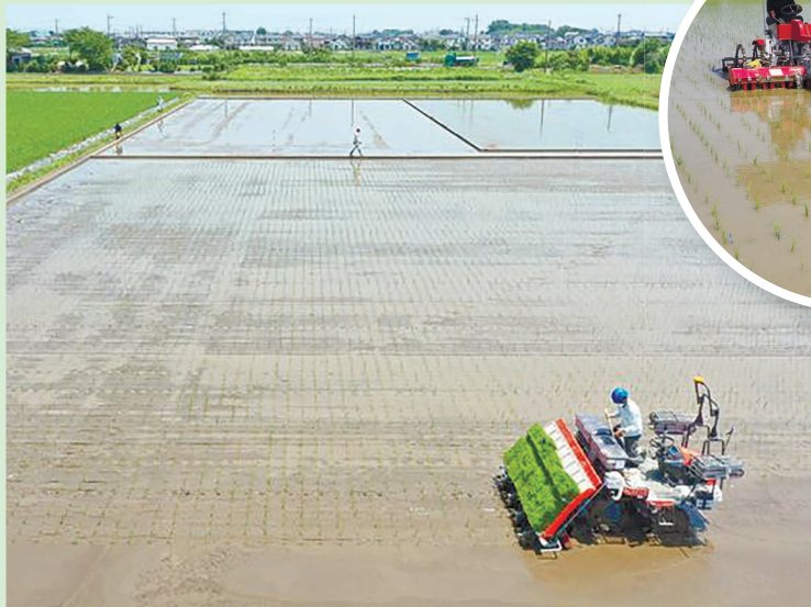
田んぼで実証実験をしている両正条田植機
