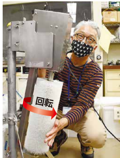
ブラシを押すと、スイッチが入って回るしくみになっています
