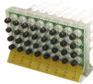
測定装置に差し込まれたガラスチューブには1個体ずつ昆虫が入られ、センサーで歩行活動量をカウントする。測定と選抜は3年以上かけて行われた
