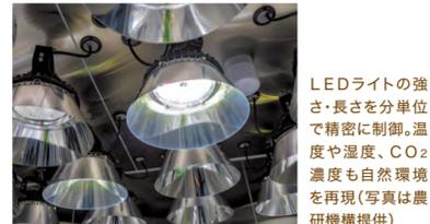
LEDライトの強さ・長さを分単位で精密に制御。温度や湿度、CO<sub>2</sub>濃度も自然環境を再現(写真は農研機構提供)
