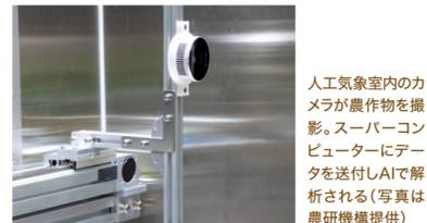
人工気象室内のカメラが農作物を撮影。スーパーコンピューターにデータを送りAIで解析される(写真は農研機構提供)
