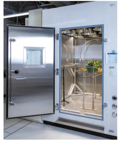
栽培環境を精密に制御し、農作物の環境応答について解析できるロボティクス人工気象室
