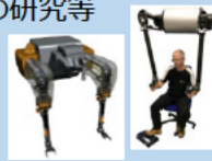
遠隔操作ロボット
