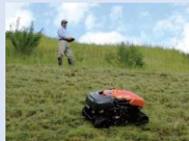
無線草刈機の運用に対応した傾斜
