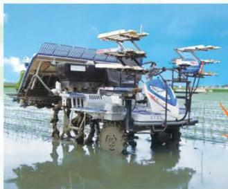
農研機構は、リモコンで遠隔操作する自動運転田植え機を開発しました。人工衛星からの電波を使って位置を把握するので、無人でも熟練者以上の速度と精度で田植えができます。
