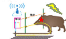
電気柵の基礎部分に通電性が高い鉄鋼スラグ等を利用
