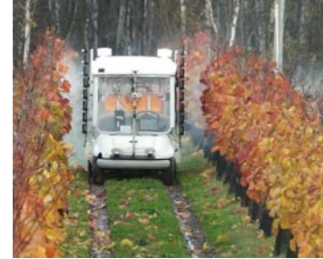
車載カメラ画像のAI解析による植物密度に応じた可変防除
