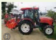
【作業機の詳細】 ・超碎土成型ロータリー(上面マルチキット仕様) ・GPS車速連動施肥機
