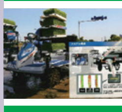
①可変施肥システム付き直進キープ田植機
