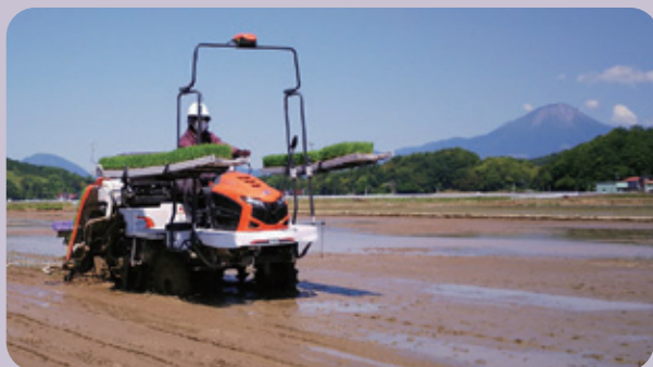
直進キープ田植機での田植作業
