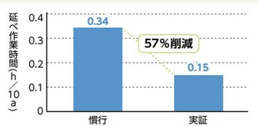
※実証:ワイドスプレッダ(散布幅10~24m)、慣行:ブロードキャスタ(散布幅6~14m)、それぞれ数種の肥料・資材を3~4回に分けて散布した時間。ながいも、ごぼう、だいこん、キャベツで調査した平均。
