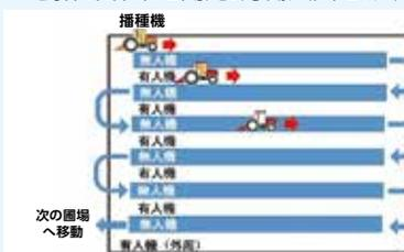
○ロボットトラクタ協調作業(実証面積: 200a) 耕耘作業は有人・無人の協調作業で行い、その後を有人播種機で播種。
