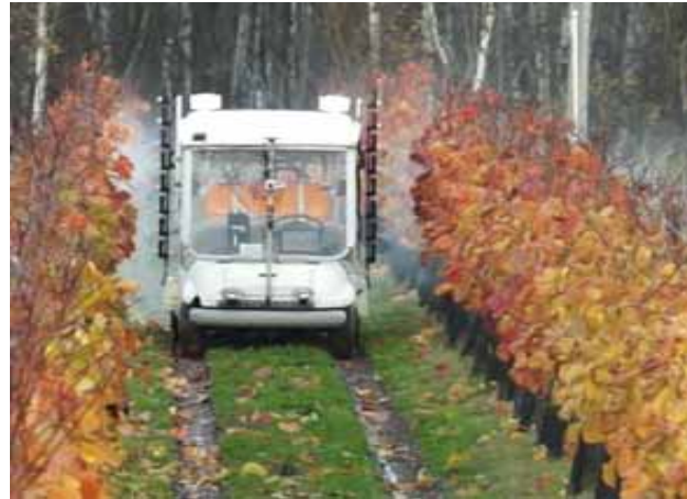
車載カメラ画像のAI解析による 植物密度に応じた可変防除
