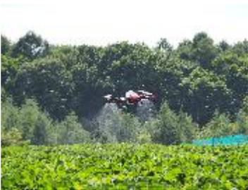
1回の薬剤搭載量を約8Lとし、薬剤補充とバッテリー交換を同時に行うことで作業時間の効率化を実現した。
