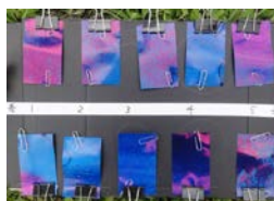
図5 感水紙による薬剤の付着評価
