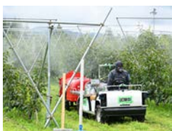
図4 自動走行車による農薬散布作業
