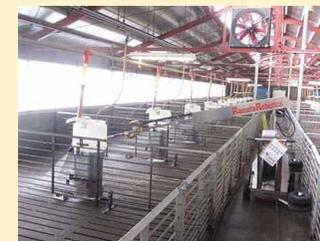
→ 日本の畜舎のサイズに適合した豚舎洗浄ロボットの開発により、豚舎洗浄作業の**大幅な省力化**。
