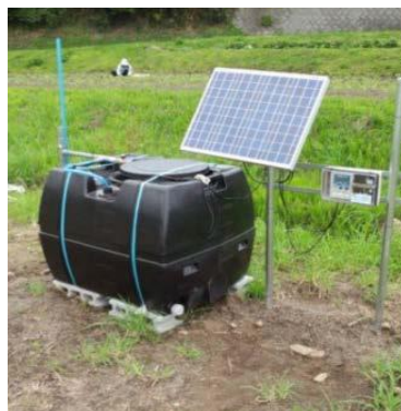
図2 ソーラー式自動かん水装置 （※電源確保の難しい園地に最適）
