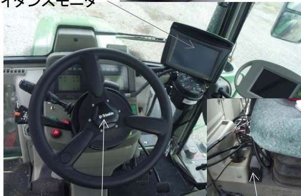
操舵モータ内蔵ステアリング ジャイロセンサ GNSS運転支援装置
