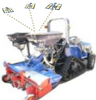
GPS 車速連動型精密施肥機により無駄のない精密施肥を可能
