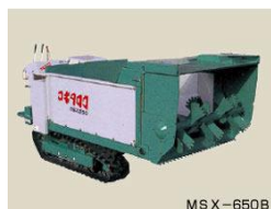
廃菌床散布に適する農機の改良
