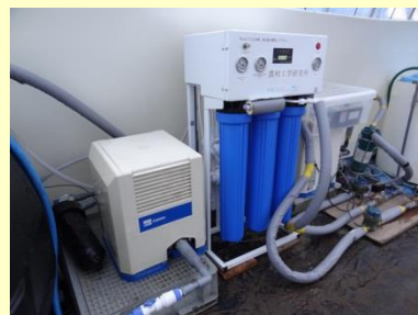
逆浸透膜装置の現地導入試験を実施* *地下水の中の浮遊物の除去と、膜表面を適宜、フラッシング洗浄する必要がある。
