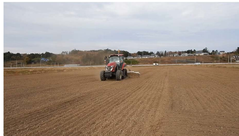
ロボット利用によりオペレータ 作業時間を半減
