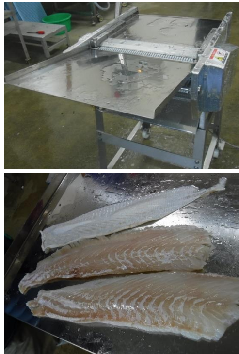
剥皮装置(上) 剥皮後フィレー(下)
