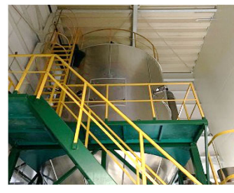
乾燥粉末化 熱風が流れる缶体内にエキスを霧状に噴霧し瞬時に乾燥
