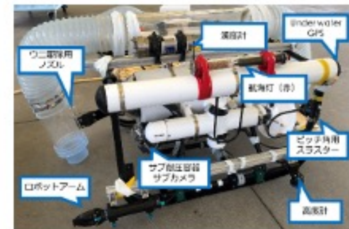
ウニ認識を使ったROV制御によるウニ回収の基礎システム 令和1年度完了
