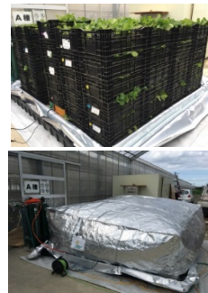
(株)アグリクリニック 研究所製の炭酸ガスくん蒸処理装置の内部(上図)と外観(下図)
