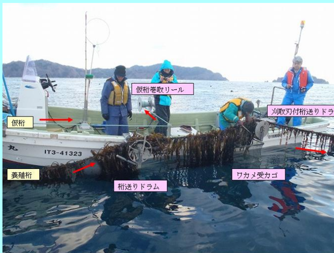
ワカメ自動間引き装置の開発に向けた実証試験 (釜石湾漁業協同組合管内漁場)
