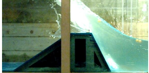
写真1 津波越流の影響評価を行うための水理模型実験
