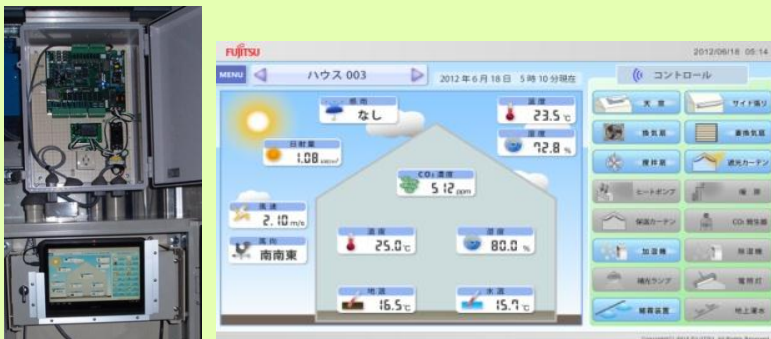
図6 ユビキタス環境制御システム(UECS)の計測制御部とソフトウェア画面(タブレット端末)
