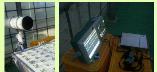
図7 レーダー計測システムの計測部とデータ収録・解析部
