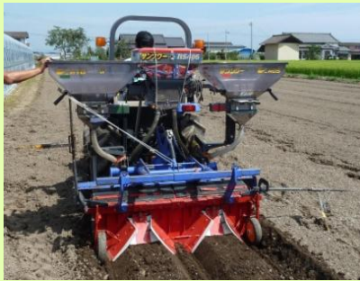
うね内部分施用機によるうね立て(8月)
