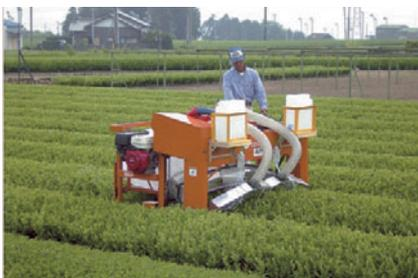
図2 送風式害虫捕集機
