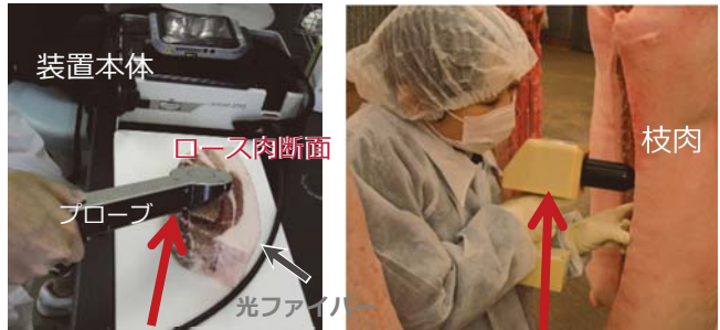
図3-2 近赤外光ファイバ法による測定
