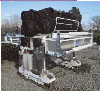
被覆アタッチメントを装着した乗用型摘採機
