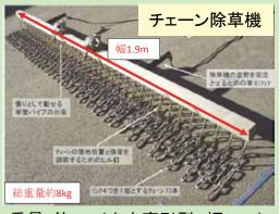
重量:約8kg(人力牽引型、幅1.9m) 小規模農家の初期導入技術に最適
