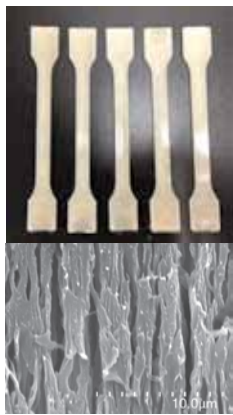
射出方向の配向構造が耐衝撃性発現に重要
