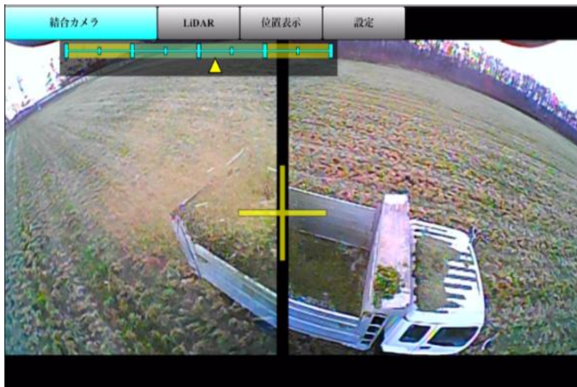
シュートに取り付けたカメラで収穫物の積み込み状況を表示
