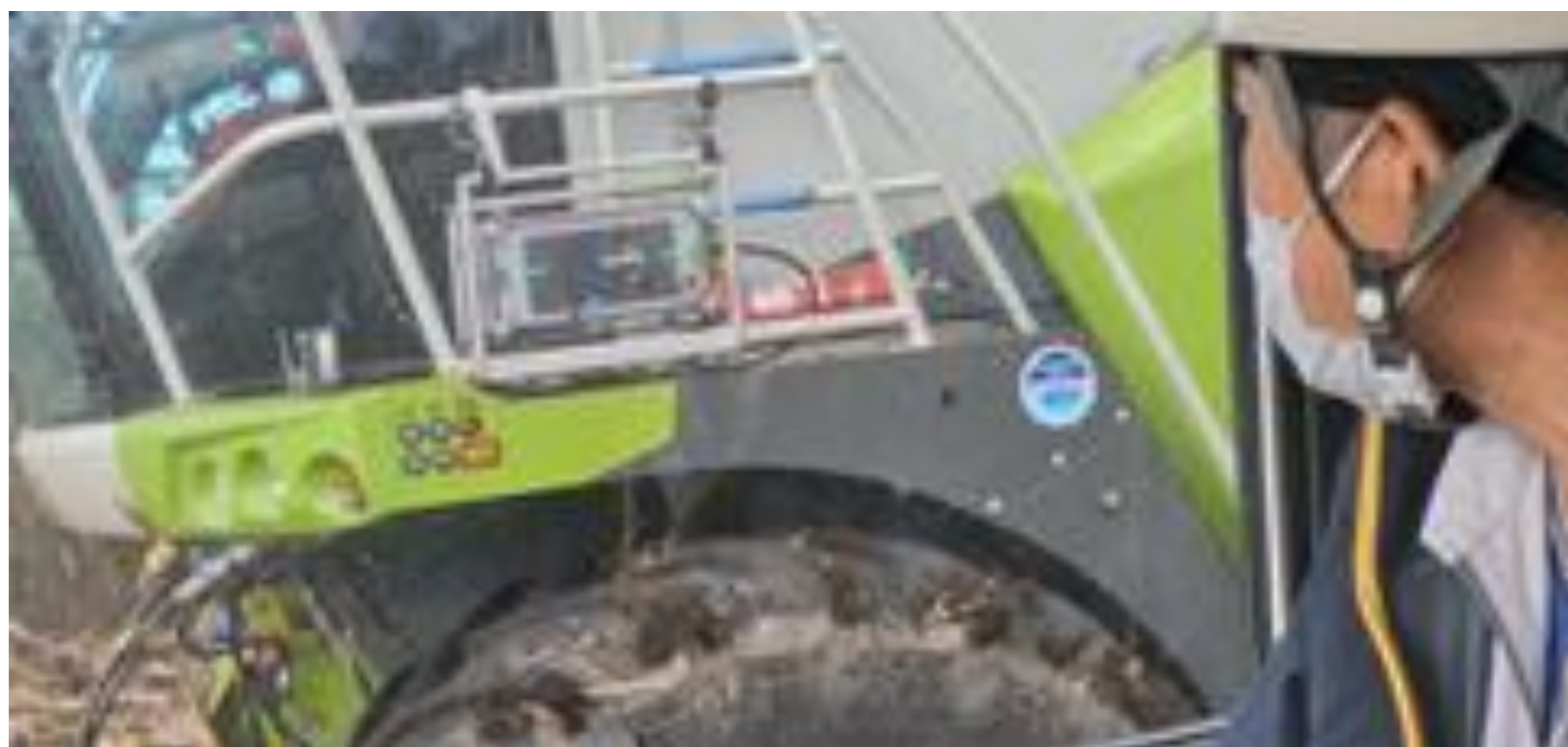
LEDパネルでトラックの位置を表示し、モバイル端末の音声でトラックを適正な伴走位置に誘導
