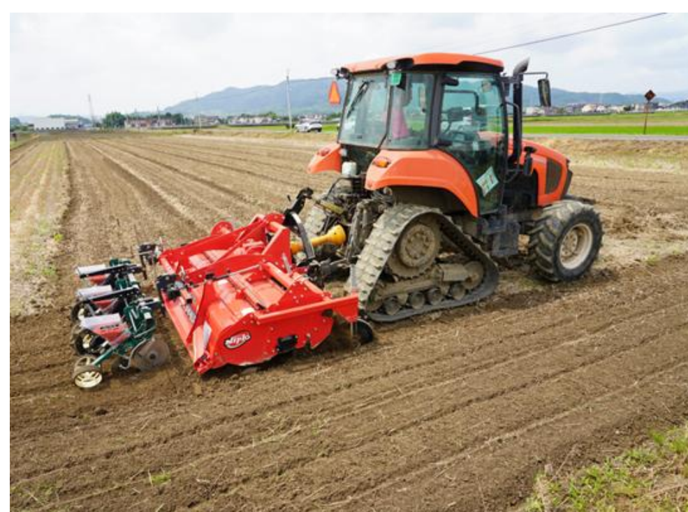
ディスク式高速一工程播種法(写真左)及び市販化された専用アタッチメント(写真右)
