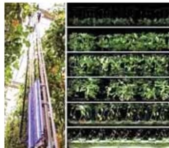
つり下げ型画像計測ロボットの外観（左）と撮影した画像（右、畝間を移動しながら複数の高さで撮影した画像をパノラマ合成）
