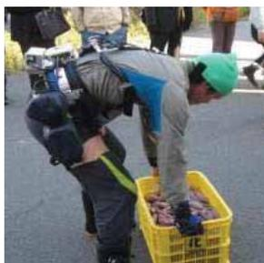
アシストスーツを使用した重量物の持ち上げ作業
