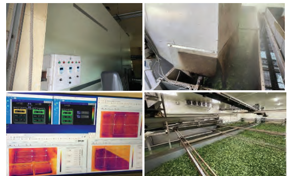
左上：低温保管庫 右上：ミスト冷却器 左下：制御パネル 右下：コンテナ内部
