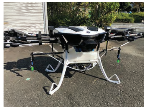
急傾斜地果樹園上空を自動航行する機能を付与した農薬散布ドローン
