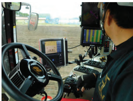
自動操舵システムによりステアリングを握らずにトラクタの直進走行が可能
