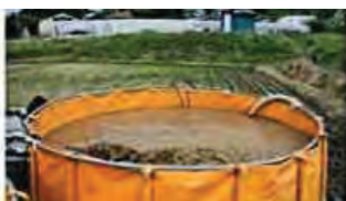
水田土壌の攪拌・凝集でセシウム除去
