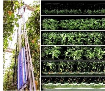
つり下げ型画像計測ロボットの外観（左）
