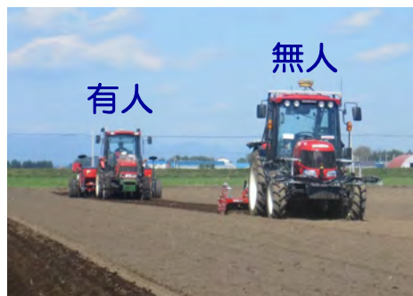
無人ロボット作業と有人作業を組み合わせることで作業能率を向上
