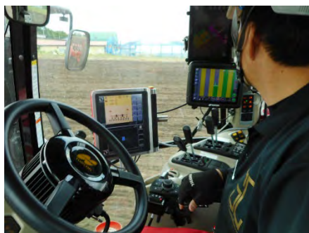
自動操舵システムによりステアリングを握らずにトラクタの直進走行が可能
