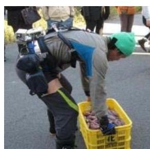
アシストスースを使用した重量物の持ち上げ作業
