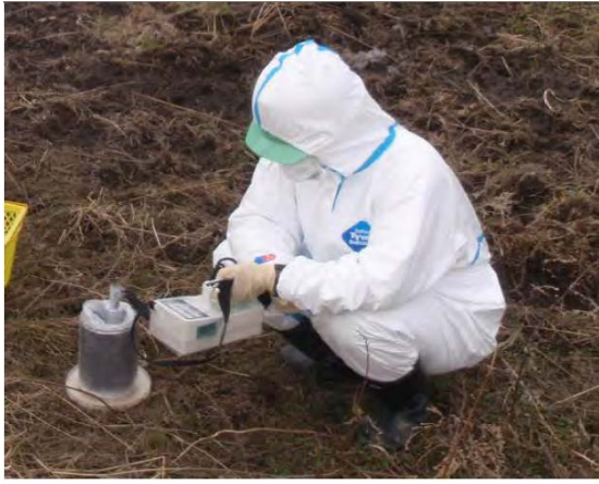
地上 1 cmの放射線濃度の測定状況
