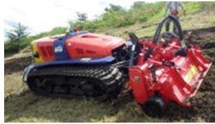
無線トラクタによる傾斜草地での耕うん作業
