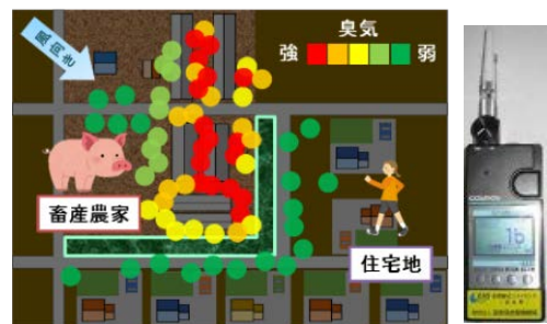
ニオイセンサとGPSを用いて 農場全体の臭気の状態を把握する 「臭気マッピング手法」
