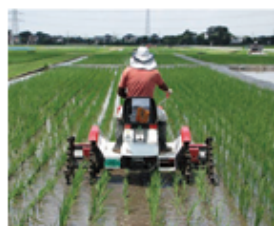
除草機による除草作業
