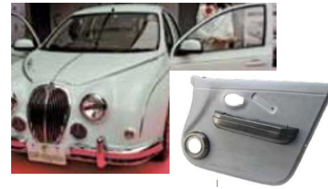
繊維強化リグニン材を用いた部材と 実装した自動車
