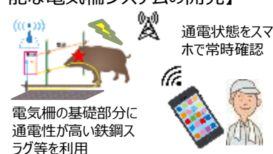
ラバーや樹脂製等、軽量資材で柵下部をL字型にカバー
