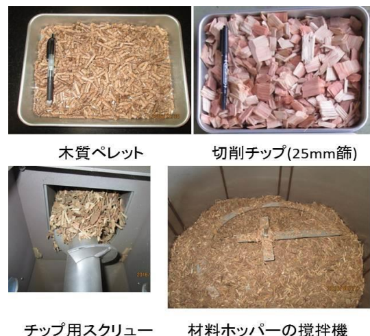
図1-1 木質バイオマス用定量供給機
