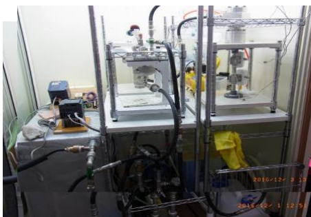
図3-2 通常ハイドレート型分離装置
