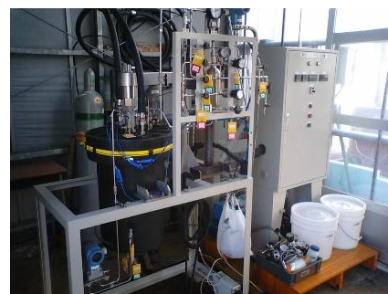
図3-3 セミクラスレートハイドレート型分離装置
