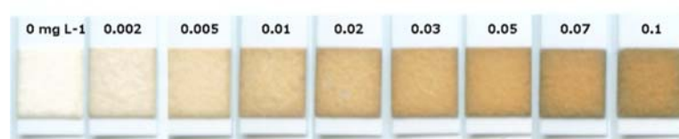
図2. 反応液中無機ヒ素濃度による硝酸銀塗布試験紙の呈色の変化
