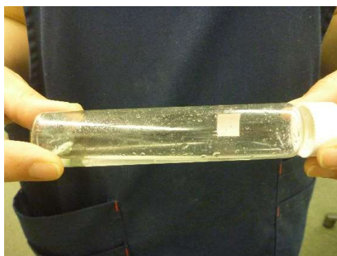
図7. バイアル内壁の付着した液の落とし込み
