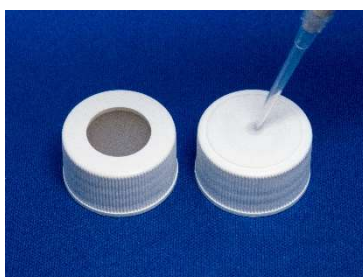
図5. 呈色用円形ろ紙への硝酸銀溶液の塗布
