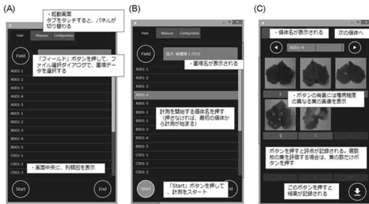
図 9 耐病性評価用アプリケーションユーザーインターフェースと操作手順
