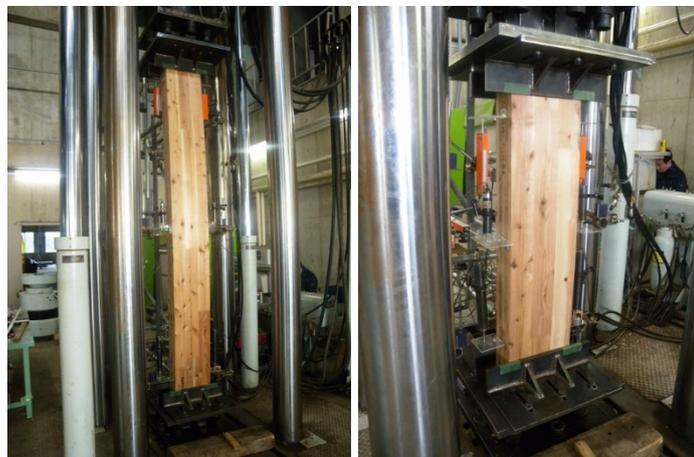
写真3 座屈試験の様子
