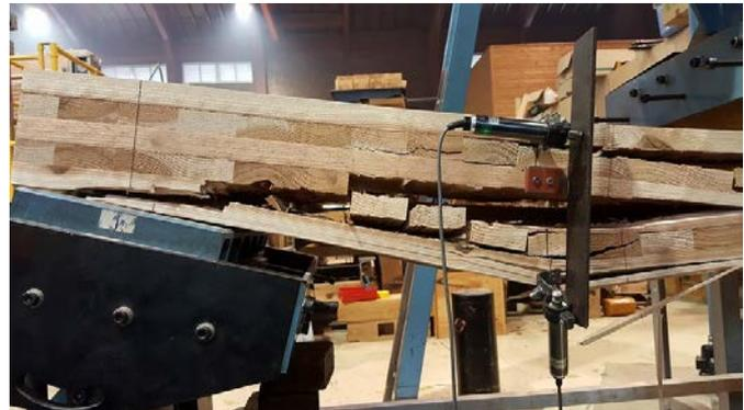
写真3 ひき板の幅と厚さの比2.5倍のせん断破壊
