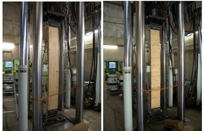
写真5 座屈試験の様子
