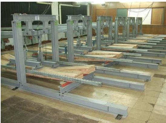
写真2 長期荷重載荷試験状況
