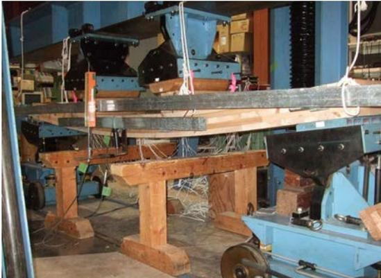
写真1 面外曲げ試験状況
