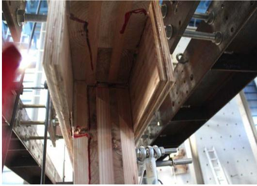
写真1 実験後の破壊の様子（表面）
