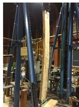
写真6 座屈試験の様子
