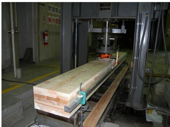
写真4 曲げ試験の様子
