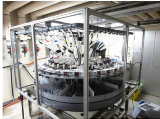
図4. 試作したターンテーブル式自動飼育装置. 36個×6列で最大216個の容器を並べることが出来る
